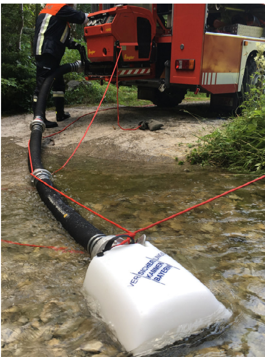
Bild 1: Schwimmsauger im Einsatz
